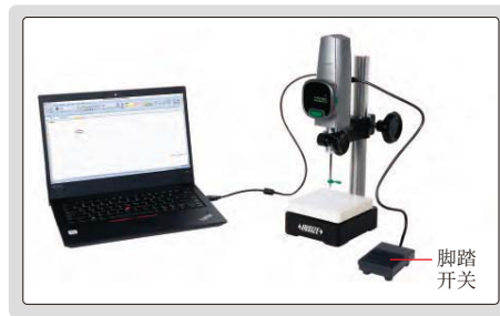
无需安装软件, 数据可传输到Excel; 短按脚踏开关采集数据, 长按置零
